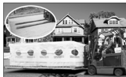
Figyeljen arra, hogy megfelelő hosszúságú targoncavillát használjon, a biztonságos szállítás érdekében!
