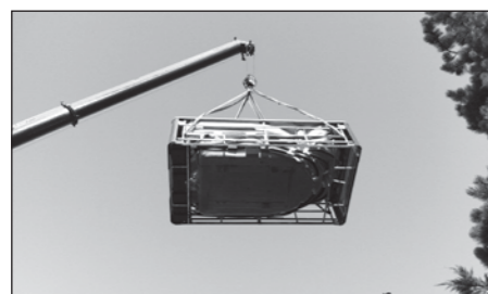
Az úszómedence felemelése előtt győződjön meg az emelődarura rögzítés megfelelő elvégzéséről!
